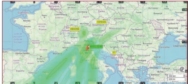
7. Radio-localización de la estación por TDoA (KiwiSDR). Fuente: IARU R1 ( https://www.iaru-r1.org/2022/iarums-successful-action/ )
